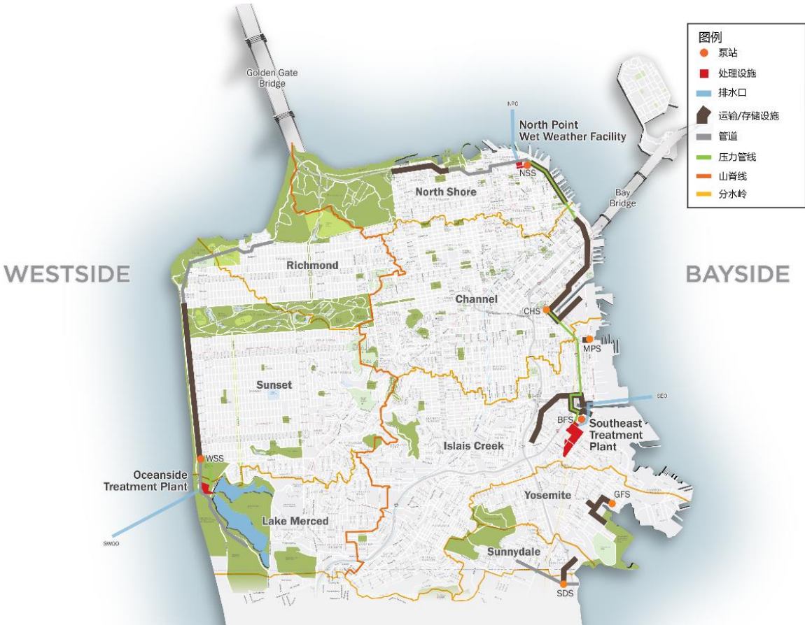
图 4.1-2 旧金山市污水、雨水处理系统
