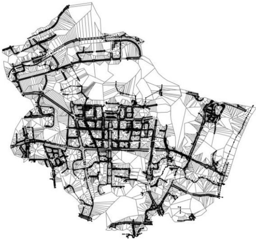
图 4.3-1 溉澜河流域子汇水区 and 管网分布
