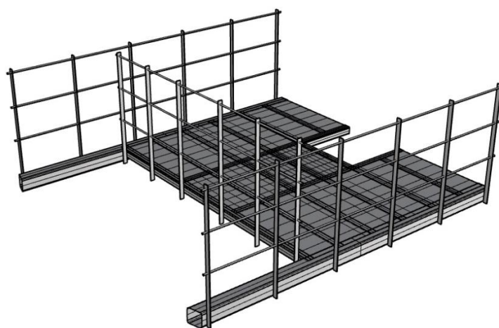
a)斜拉索锚点检查平台
