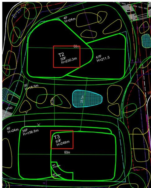
问题 2：超高层建筑在顶层局部升高，当高出部分层数超过一层时，整栋建筑的消防救援场地是否可以设计成（满足一个长边的长度或大于周边长度的 1/4 即可，如下图），布置位置不正对建筑的长边？
