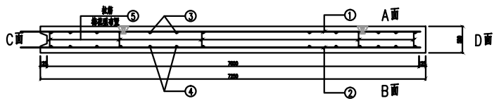
预制构件ZTB2 立面配筋图 1:20
