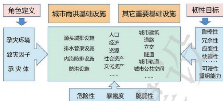
图 3.0.2 城市雨洪基础设施管理体系图
